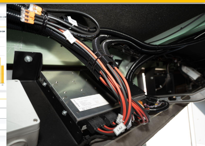
Solar-Laderegler im Dach verbaut
