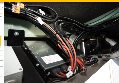
Solar-Laderegler im Dach verbaut
